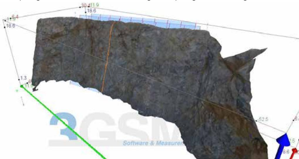
Abbildung 2: 3D Planung der Sprenganlagen
